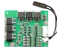
Система контроля и управления батареи (~10% стоимости ячеек)
